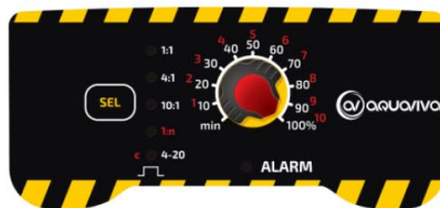
Wskaźniki LED trybów dzielenia 1:1, 4:1, 10:1 i mnożenia 1:(od 1 do 10) dozowania proporcjonalnego względem sygnału zewnętrznego z wodomierza z wyjściem impulsowym
